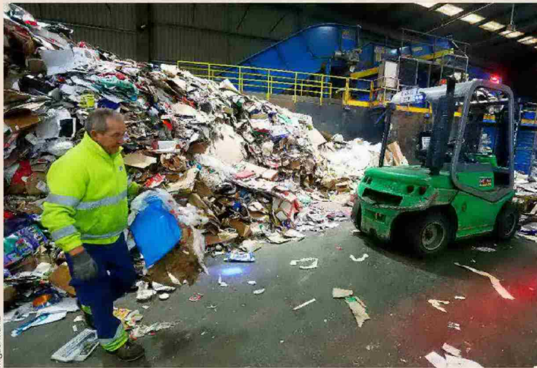
La planta de Coregal utiliza luces rojas como medida de seguridad para trabajadores con sordera.
